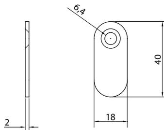
Nur bei der Schiebeleiter notwendig, Montage links / rechts auf die Enden der Laufschiene
